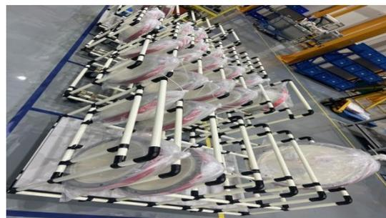
改善后：使用带轮线棒架放置代替叉车，提高流转效率，节省叉车电能损耗
